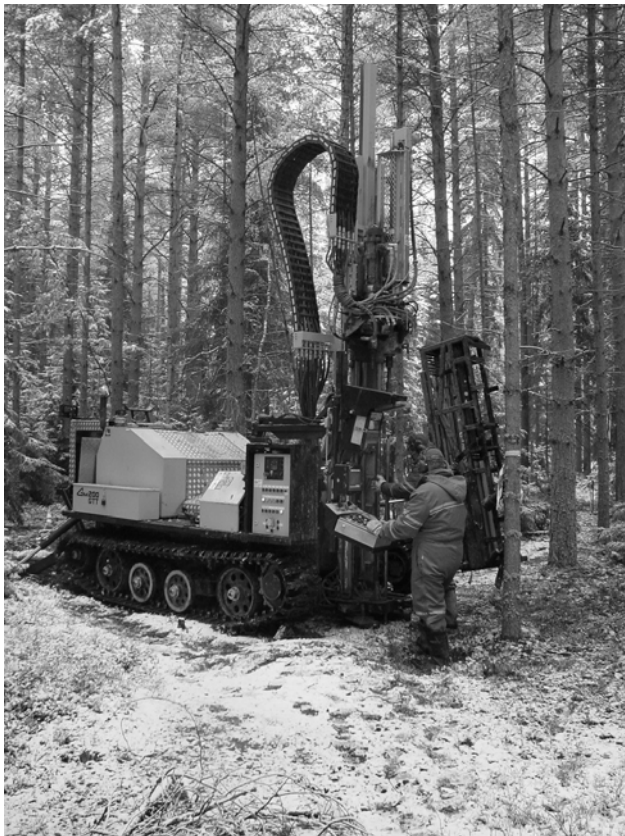
Kuva 2 Helsingin geoteknisen osaston käyttämä raskas monitoimikaira GM 200 /15/.
