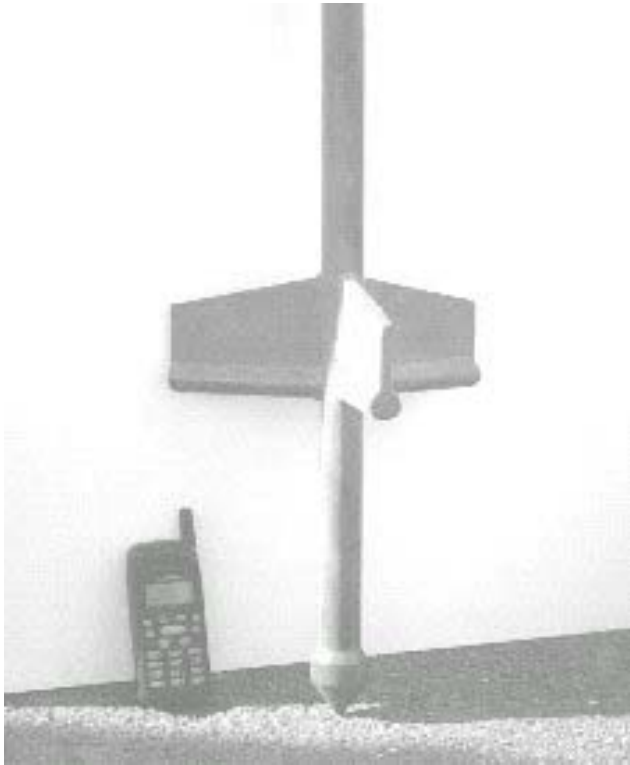
Kuva 4 Helsingin kaupungin geoteknisen osaston pilarikairauksessa käyttämä kolmisii- pinen kärkikappale /15/.
