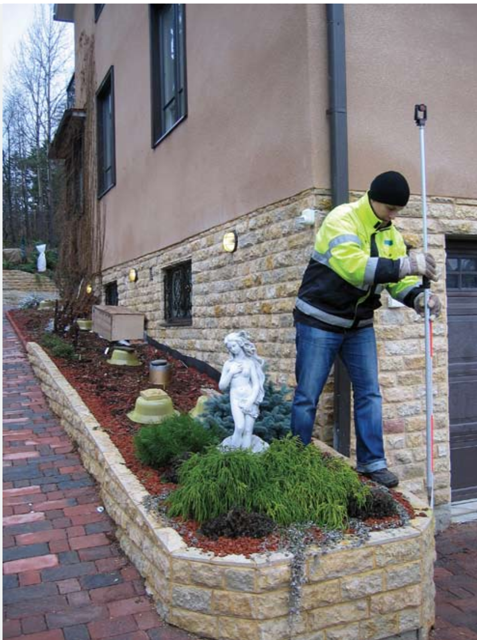
Simo Manninen pitää prismaa takymetrimittauksessa. Simo Manninen håller prisma vid takymeternmätning.
