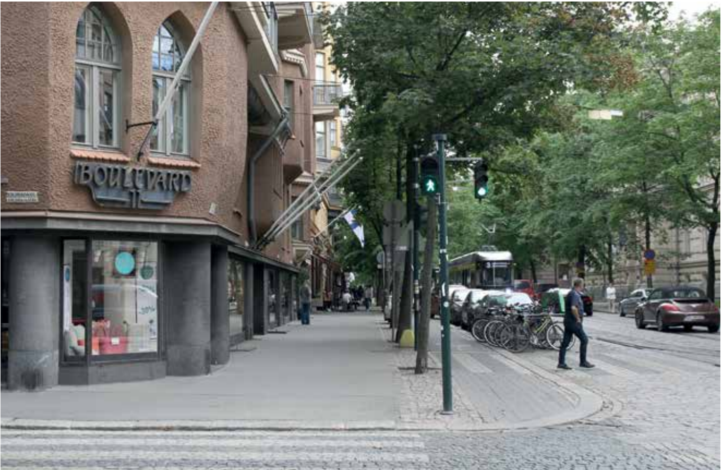
Kuva 95, yllä. Katunäkymä Bulevardin jalkakäytävää pitkin Fredrikinkadun risteyskohdalta itään. Jalkakäytävä ja pyörätie ovat asfalttipintaisia ja niiden välissä on nupu- tai noppakivetty luonnonkivikaistale. Ajourata
