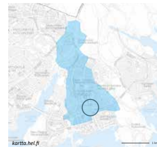
Vuosaaren pohjavesialue. Suunnittelualue sijaitsee laajalla vedenhankinnan kannalta tärkeällä pohjavesialueella, mikä asettaa vaatimuksia alueen hulevesien käsittelylle.
