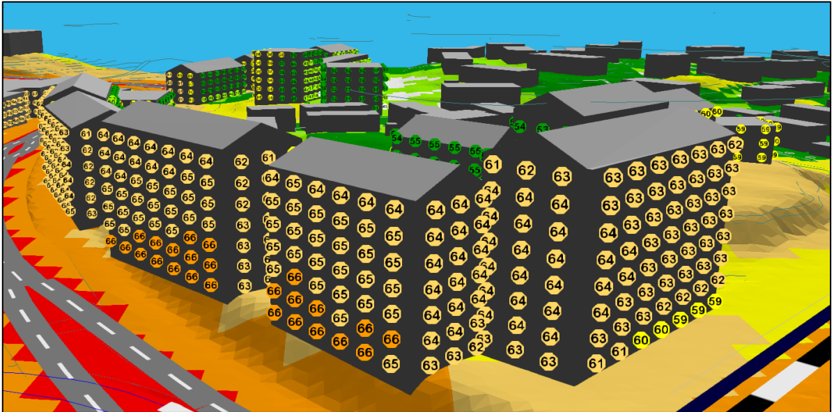
Kuva 6. Oulunkyläntien ja raitiotien risteuksen vieressä sijaitsevien asuinrakennuksien julkisivuille muodostuvat keskiäänitasot kerroksittain päiväaikaan.
