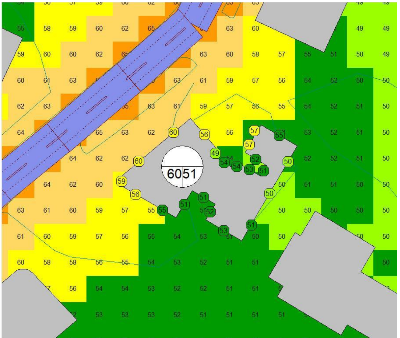
Kuva: Malminraitti 3 päivääajan melutasot nykytilanteessa. Nykyliikenne: Malminraitti, KAVL 3100 ajon/vrk, raskas liikenne 4%, nop.raj. 30 km/h (laskentavuosi 2016).
