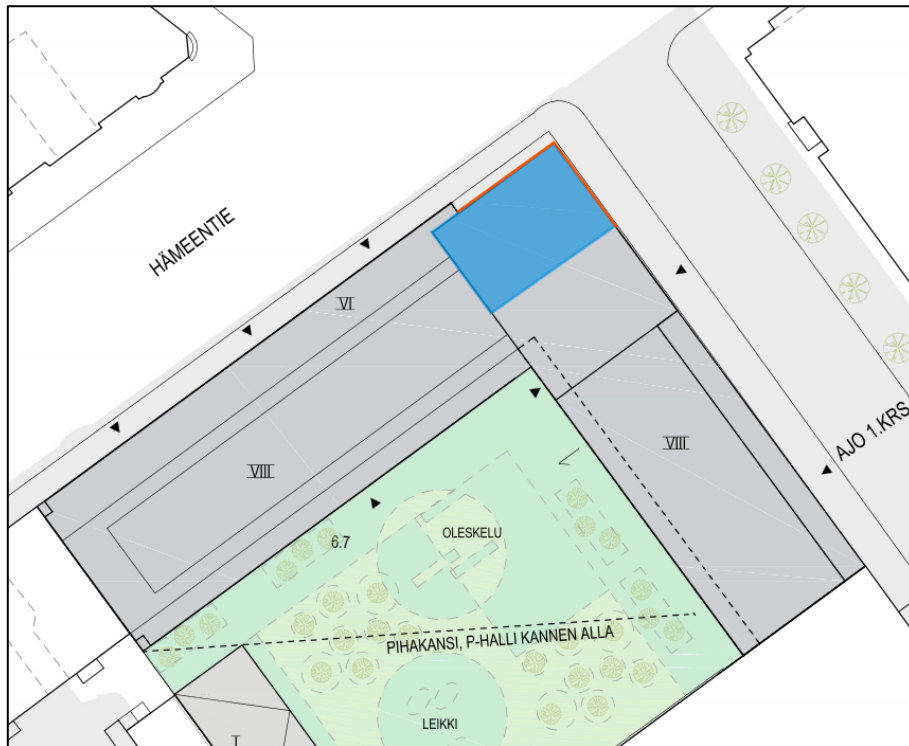
Kuva 4: Runkomelun vaimennusalueet: vaakasuuntaiset vaimentimet (sininen) ja pystysuuntaiset vaimentimet (oranssi).
