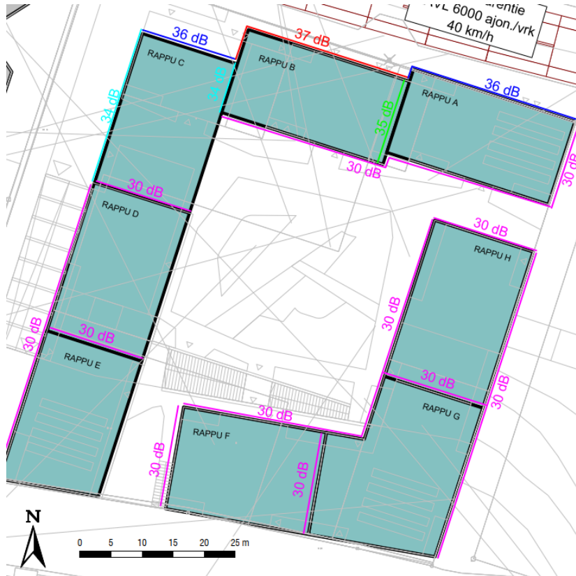
Kuva 1. Melumallituksen mukaiset ulkovaipan äänitasoerovaatimukset.
