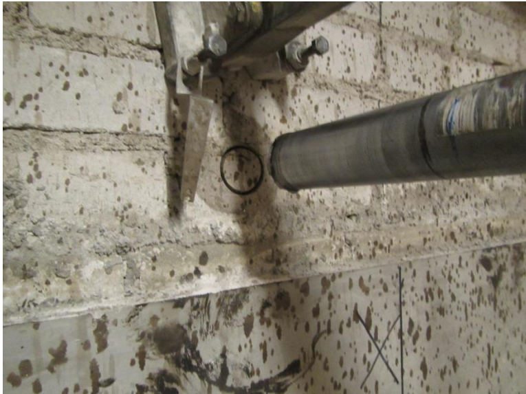
Kuva 38. Näyte WMY 58 otettiin seinästä kohdasta, jossa oli öljyroiskeita.
