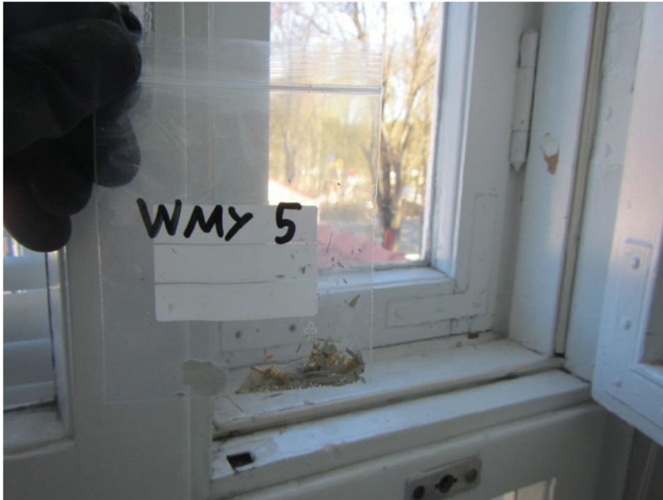
Kuva 16. Valkoinen ikkunamaali sisältää haitallisen määrän sinkkiä (WMy 5).
