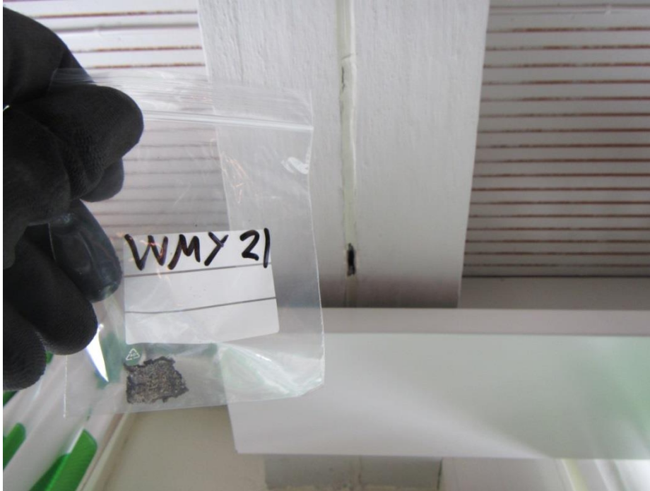
Kuva 14. Liikuntasauman tervapaperi sisältää PAH-yhdisteitä ja bentso-a-pyreeniä. (Näyte WMY 21)
