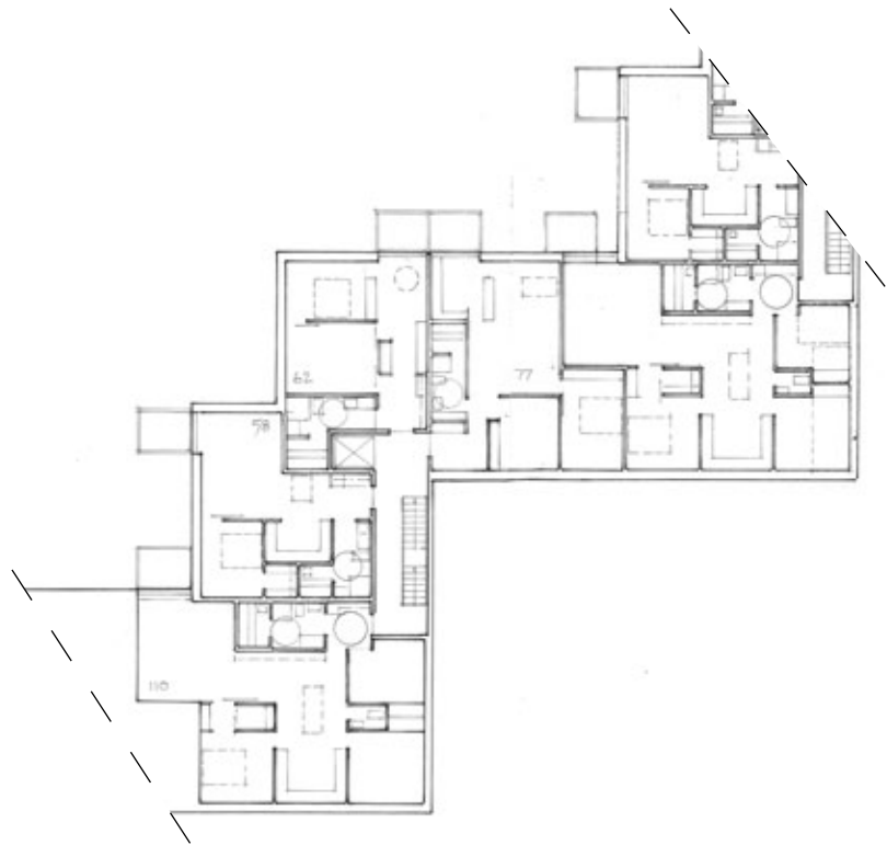
Ote sik-sak-rakennuksen normaalikerroksen pohjakaaviosta.
