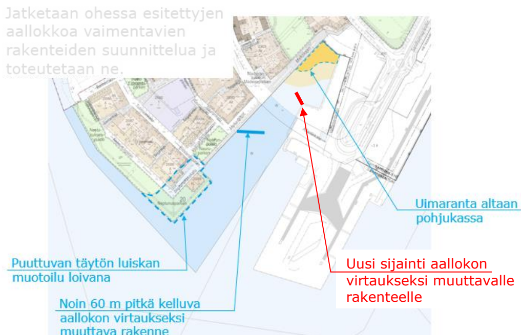
Kuva 21: Aallonvaimennusrakenteiden vaihtoehtotarkastelussa esitetty paikka aallokon virtaukseksi muuttavalle kelluvalle laiturille (Ramboll ja Akateemiset konsultit 1.2.2020) sekä punaisella uusi sijainti tämän tarkastelun perusteella.
