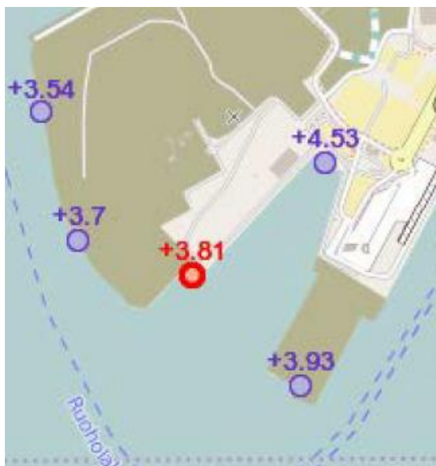
Kuva 2: Ahdinallas vuoden 2016 aaltoselvityksen aikana silloisten altaan geometrian ja rakenteiden mahdollistamat alimmat rakentamiskorkeudet (Geoteknisen osaston julkaisu 96).
