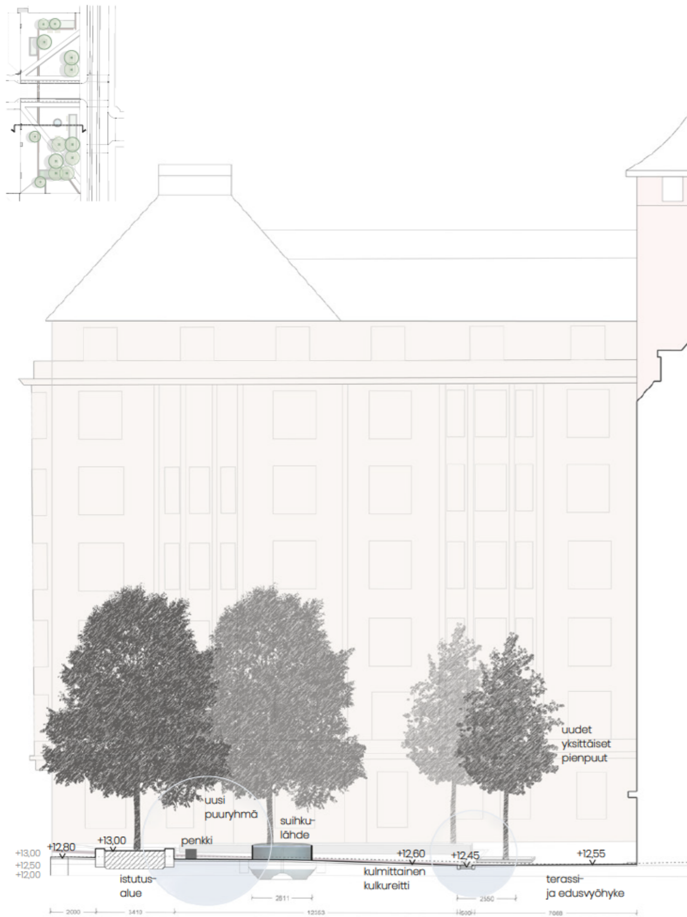
Leikkaus E-E' 1:150 torin poikki Punavuorenkadun suuntaisesti. Leikkauksessa näkyvät istutettavat puut, paasikivimuurialtaat sekä uusi suihkulähde ympäröivine penkkeineen.
