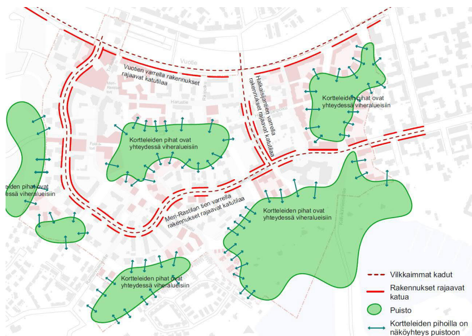
Rakentamisen ja julkisen ulkotilan rajapinnat.
